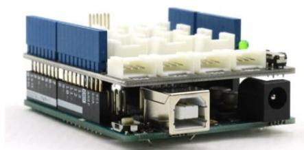
Figure 1 : carte de commande Arduino Uno avec shield Grove
